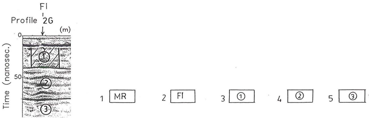
**Abb. 8:** Šumice bei Uherský Brod, Bez. Uherské Hradiště: Die GPR-Ergebnisse am PF 1 G und PF 2 G in der Bauachse und im Presbyterium. 1 - Reste der Grundmauer; 2 - Flächeninhomogenität; 3 - Anthropogene Ablagerungen; 4 - Lettenerden, Letten (Lehm); 5 - Schottersande.
